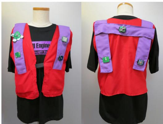
Esta imagen muestra un proyecto de e-textiles creado con un kit que ofrece un sistema de *plug-and-play* pensado para introducir al alumnado de forma amigable a conceptos computacionales.
