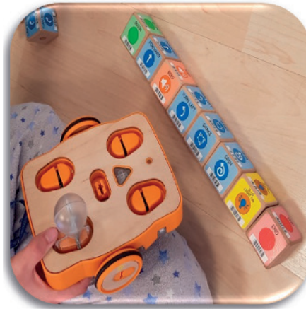
Figura 3 Programación y lectura realizada a través del escáner de KIBO
