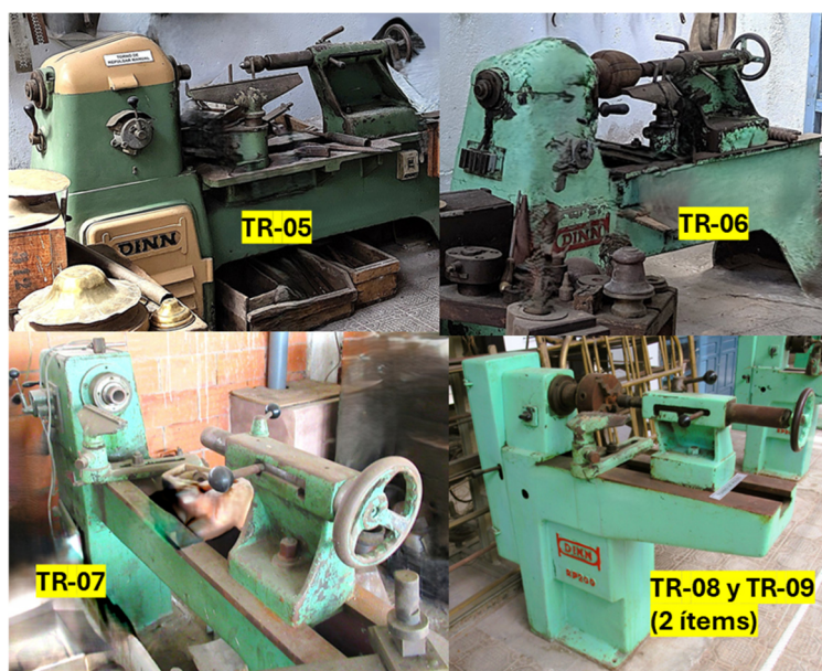
Fig. 5. Los cinco tornos de repulsar (cuatro modelos) del Grupo B del Museo de Riópar. Excepto en el torno TR-09, se aprecia, en primer plano, la regleta de apoyo de la herramienta manual de repulsar (fotografías de los autores).
