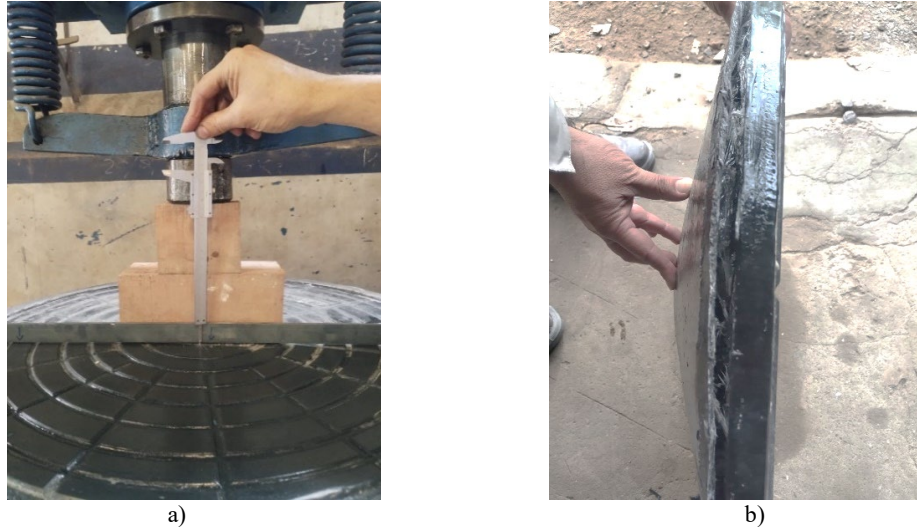
Fig. 7. Ensayo de tapa troncocónica; a) montaje en marco experimental; b) falla por desprendimiento del laminado inferior.
