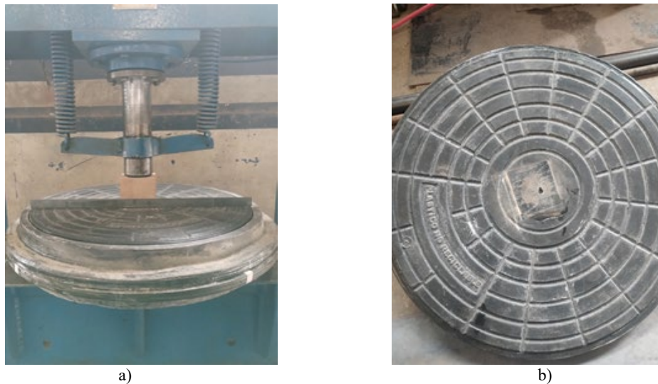
Fig. 4. Ensayo de placa plana; a) montaje en marco experimental; b) falla por compresión en la parte superior de la placa.
