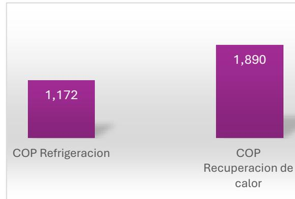
Fig. 5. Comparación COP Refrigeración V/S COP Recuperación de calor. Fuente: Elaboración Propia.
