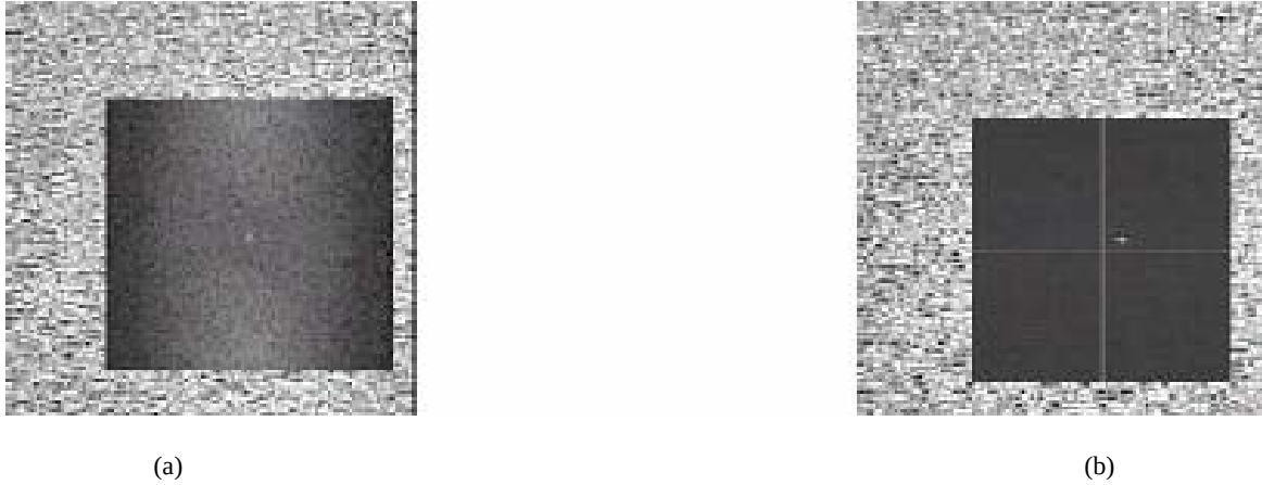
Fig. 5. Aspecto das FFT realizadas durante o processamento. (a) halo de difracção de uma das sub-imagens e (b) correlação cruzada, mostrando o pico correspondente ao deslocamento médio dos pontos da sub-imagem.
