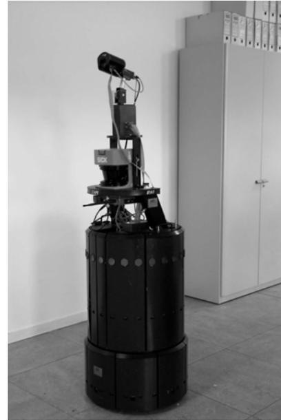
Fig. 13. Posición del telémetro láser y sistema de visión en el robot 21.
