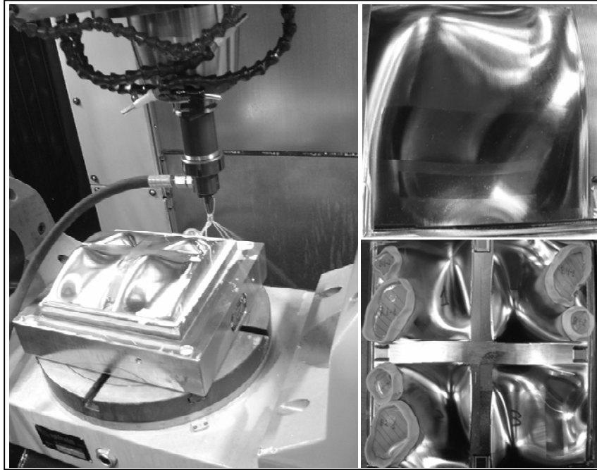
Fig. 10. Aplicación del BB a la pieza CSP. Dcha.) Detalle del acabado. Abajo) Toma de muestras en resina para medida de topografía en un perfilómetro.
