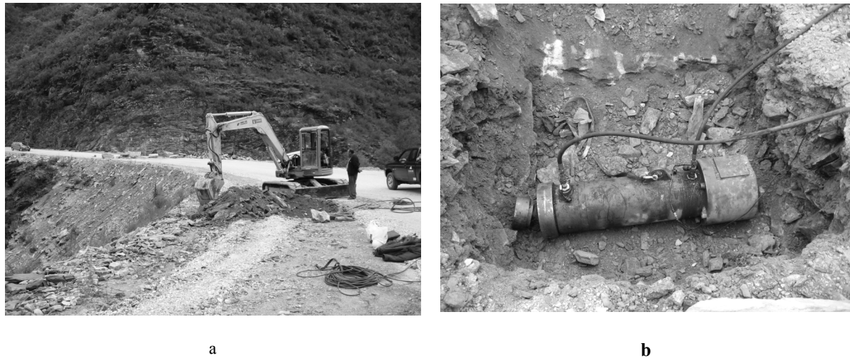
Fig. 7. Ensayo de hincamiento mediante cilindro hidráulico.
