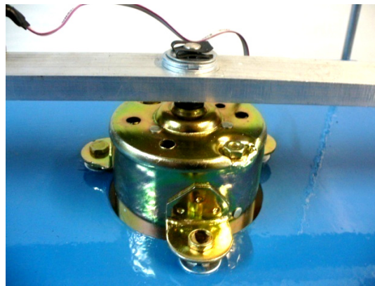
Fig. 6. Motor y brazo horizontal ya construido.
