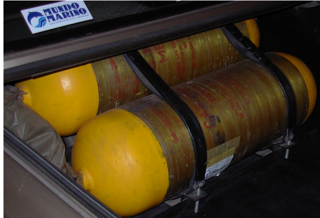
Fig. 2. Cilindros de GNC Tipo 2 (acero PRFV) montados en un vehículo.
