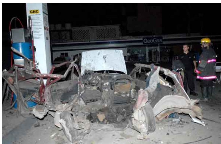
Fig. 1. Explosión de un Cilindros Tipo 3 en una estación de carga [10].
