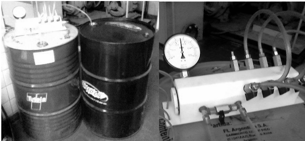
Fig. 4. Izquierda: Sistema de ensayo con los dos tanques y el Manifold. Derecha: Detalle del Manifold con las válvulas de maniobra, el manómetro común y al frente, las mangueras de conexión para el manómetro diferencial.
