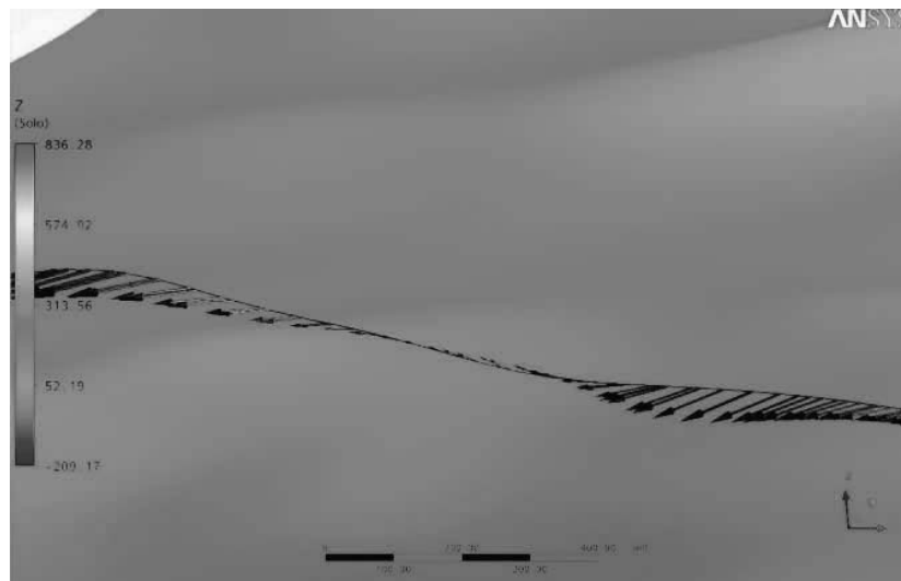
Fig. 19. Vetor resultante da velocidade de vento a 10 m de altura do solo ao longo da linha.
