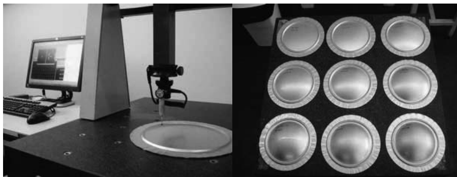
Fig. 13. Medição 3D dos provetes obtidos para diferentes pressões de bulge .
