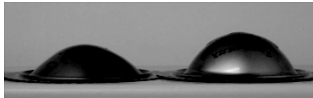
Fig. 15. Componentes ensaiados até à rotura: aços DP590 (esquerda) e AISI 304 (direita).
