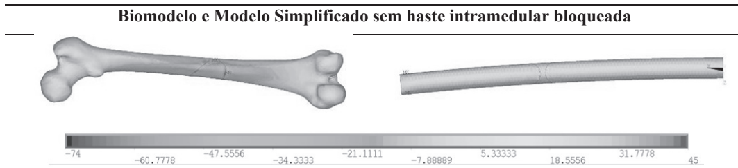
Fig. 6. Tensões normais em flexão plana nos modelos sem haste, MPa.
