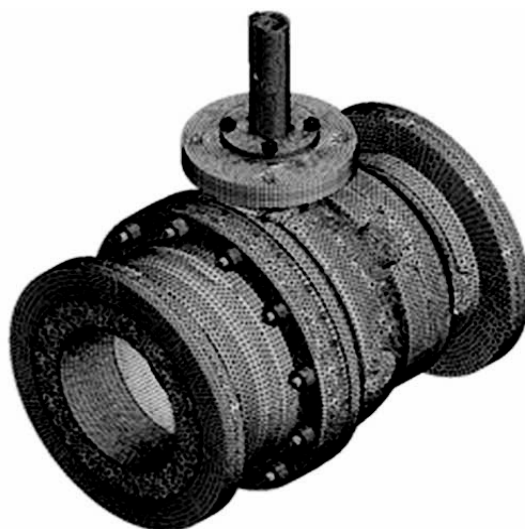
Fig. 2. Malha gerada no conjunto da válvula.
