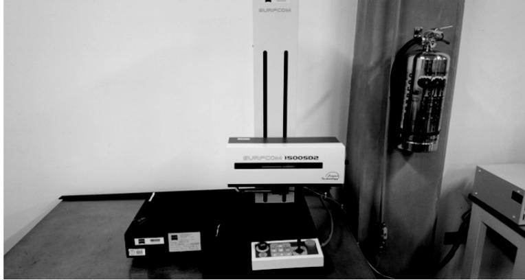
Fig. 1. Rugosímetro CARL ZEISS modelo SURFCOM 1500SD2.
