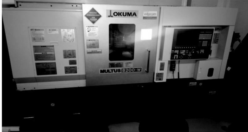
Fig. 3. Torno multifuncional CNC marca Okuma modelo Multus B-200W.
