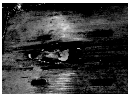
Fig. 1. Ponto de desgaste aço Hardox-450.
