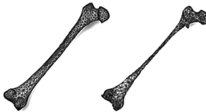
Fig. 4. Obtención de los modelos de huesos a modelos CAD sólidos: a) Modelo de fémur cortical. b) Modelo de fémur trabecular. Fuente: Los autores.
