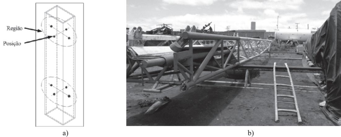
Fig. 5. Exemplo dos pontos de medição de espessura de parede.
