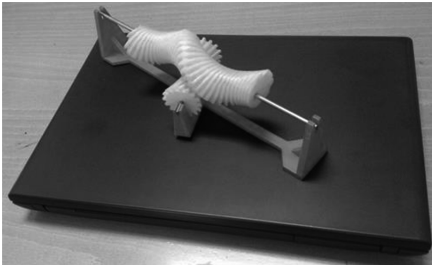
Fig. 8. Mecanismo de transmisión rotación-helicoidal con engranajes obtenidos por impresión 3D.
