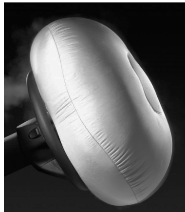
Fig. 6. Saco airbag desplegado.
