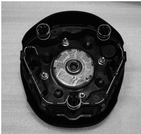
Fig. 4. Módulo airbag (vista posterior).
