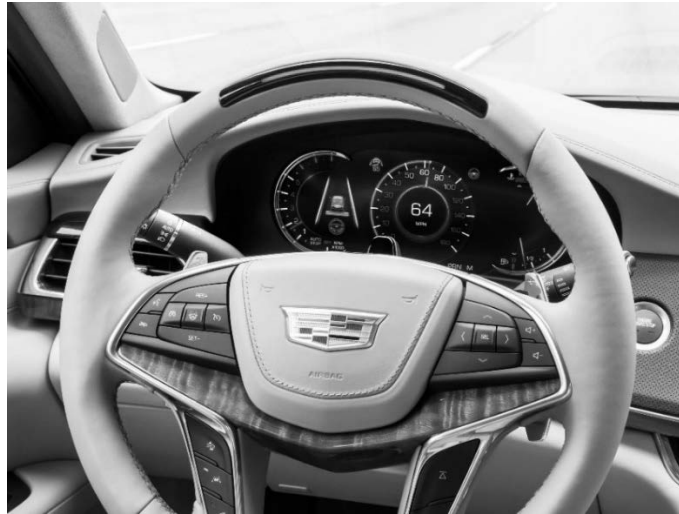
Fig. 7. Luces de aviso en aro de volante Cadillac CT6.
