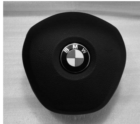
Fig. 5. Módulo airbag (vista frontal).
