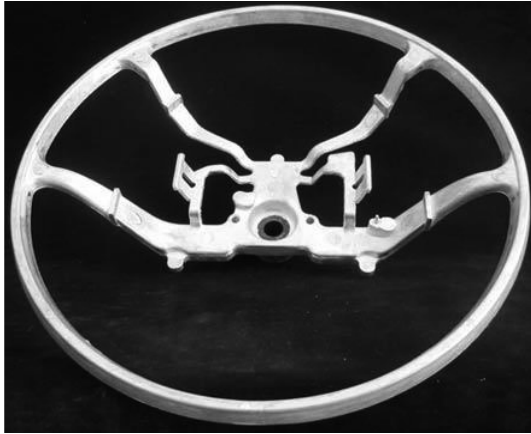
Fig. 2. Armadura de un volante.
