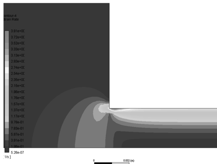
Fig. 13. Distribuição de taxa de cisalhamento na simulação com muco mimetizado para vazão de 4,6 mg/s.
