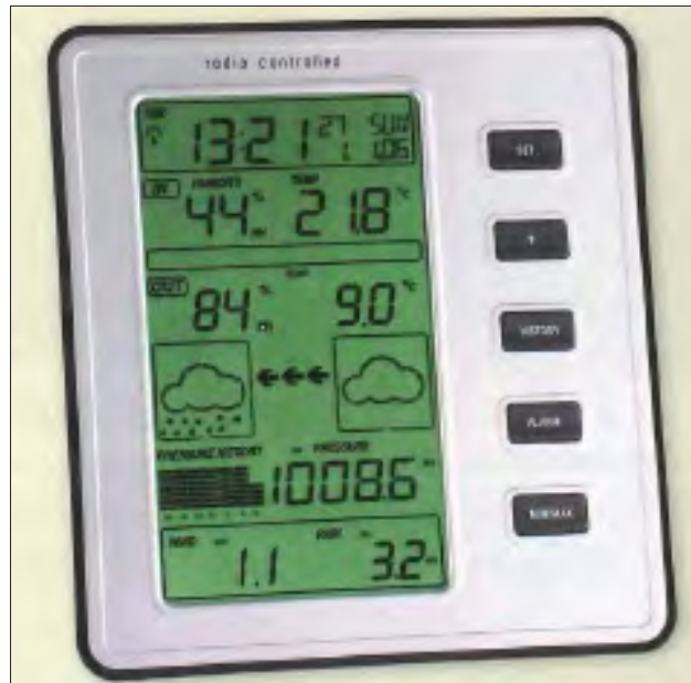
FIGURA 8. IMAGEN DE UN DATA LOGGER DONDE SE PUEDE OBSERVAR EL REGISTRO DE DIFERENTES ELEMENTOS CLIMÁTICOS (EDITORIAL BROMERA, 5º DE EDUCACIÓN PRIMARIA). Fuente: Gregori y Viu (2014)
