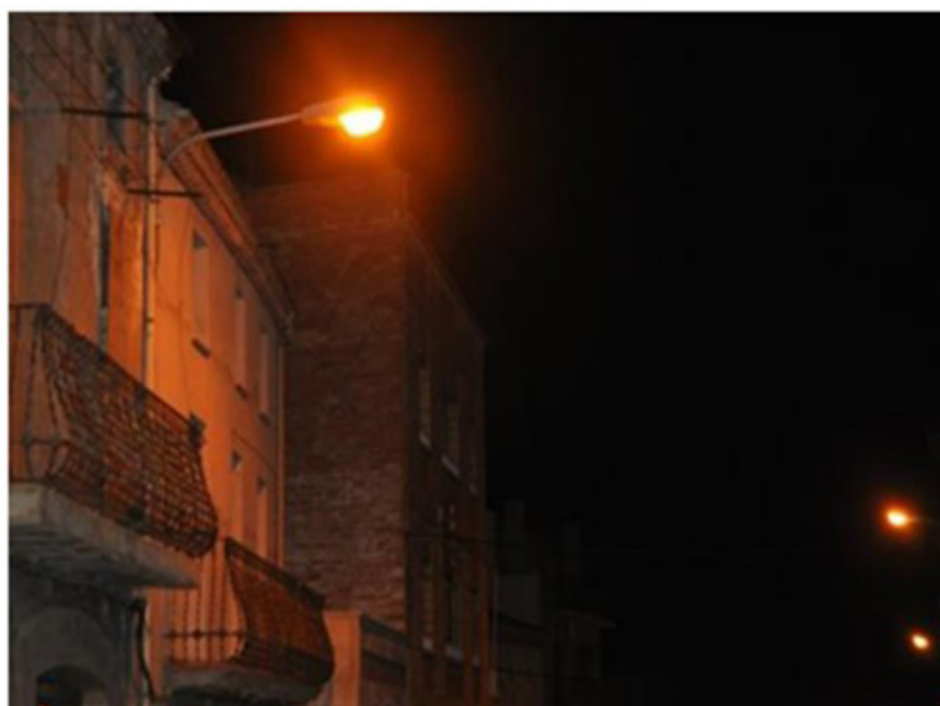
FIGURA 3. IMAGEN DEL EFECTO DE INTRUSIÓN LUMÍNICA CAUSADO POR EL MODELO DE LUMINARIA DE PARED EN LA CARRETERA DE TREMP POR LA NOCHE. Fuente: autores
