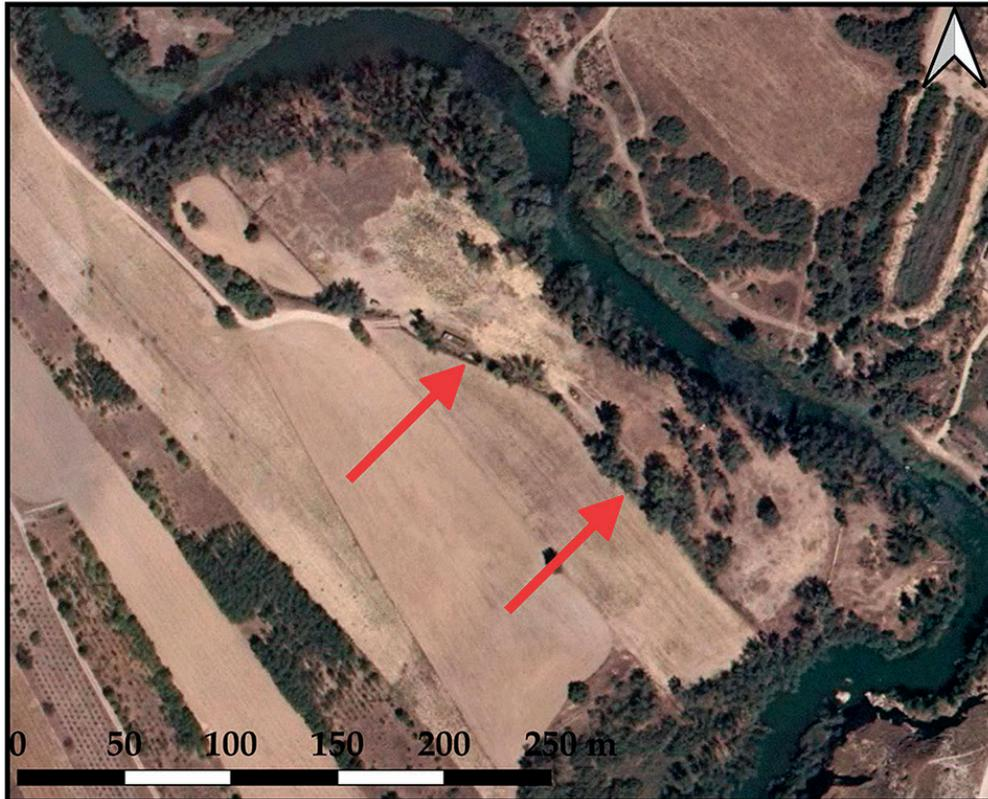
FIGURA 5. IMAGEN OBTENIDA CON EL PNOA 2006 DEL IGN, DONDE SE OBSERVA EL ESCALÓN CREADO POR LA RUINA DEL AZUD
