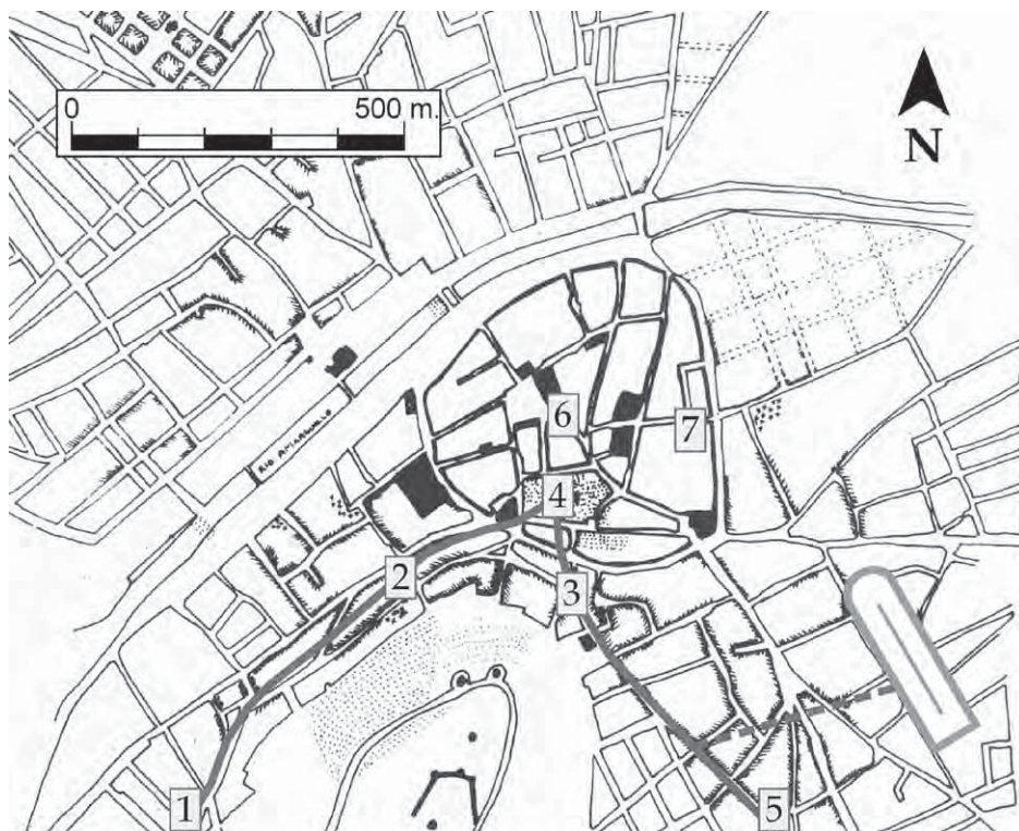
Figura 15: Red urbana de distribución de aguas de Consabura, "la teoría de los dos caños". Elaboración propia sobre plano de FERNÁNDEZ-LAYOS, Juan Carlos (1990): 1. Specus procedente del Camino de Sta. María y de Fuente Aceda; 2. Specus aparecido en la C/ Urda; 3. Specus de la C/ Ronda de la Cuesta; 4. Castellum aquae de La Tercia; 5. Specus-Estanques romanos y su posible doble dirección para abastecimiento del circo; 6. Specus-fistula plumbea de la Plaza de España; 7. Specus de la C/ Espejo.
