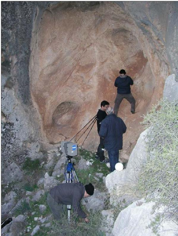
FIGURA 10. TRABAJO DE DOCUMENTACIÓN EN FUENTE DE LOS MOLINOS CON ESCÁNER LÁSER 3D. PROYECTO VELAD. VÉLEZ BLANCO (ALMERÍA). AÑO 2015. (IMAGEN DEL AUTOR)
