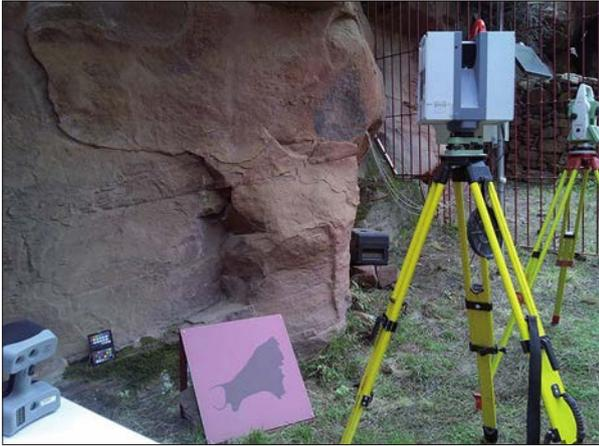
FIGURA 9. ESCÁNER 3D DE LUZ BLANCA ESTRUCTURADA, ESCÁNER LÁSER 3D Y ESTACIÓN TOTAL EN EL PROCESO DE DOCUMENTACIÓN GEOMÉTRICA DEL ABRIGO DE LA CERRADA DEL TÍO JORGE O TÍO JOSÉ. ANGÁS. (TOMADO DE ANGÁS PAJAS Y BEA MARTÍNEZ 2015)
