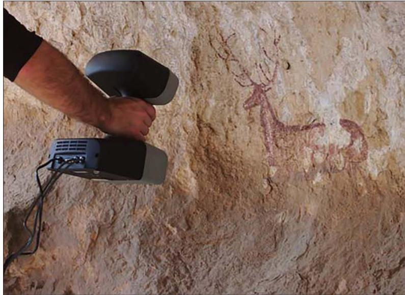
FIGURA 12. DIGITALIZACIÓN MEDIANTE ESCÁNER 3D DE LUZ BLANCA ESTRUCTURADA. ABRIGO DE CHIMIACHAS (PARQUE CULTURAL DEL RÍO VERO. HUESCA). (TOMADO DE ANGÁS PAJAS Y BEA MARTÍNEZ 2014)
