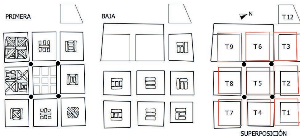
FIGURA 7. BÓVEDAS DEL EDIFICIO B Y DISTRIBUCIÓN DE MOTIVOS EN LAS CLAVES
